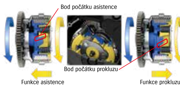
Schéma činnosti asistenčního systému spojky
